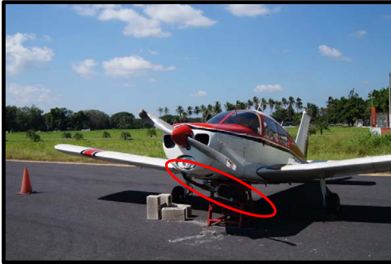
Fotografía No. 7 Nótese la dobladura y quebradura del amortiguador.
