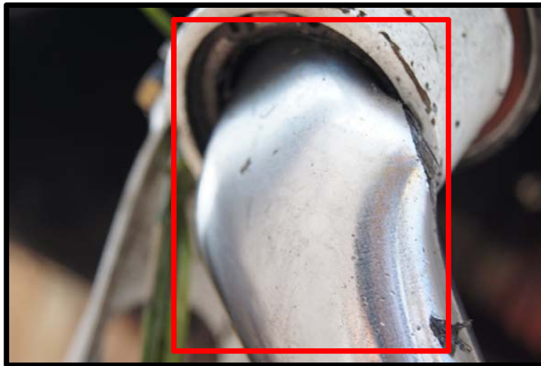
Fotografía No. 9 Amortiguador doblado.
