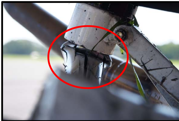
Fotografía No. 10 Tubo del Amortiguador dañado por el aterrizaje violento.
