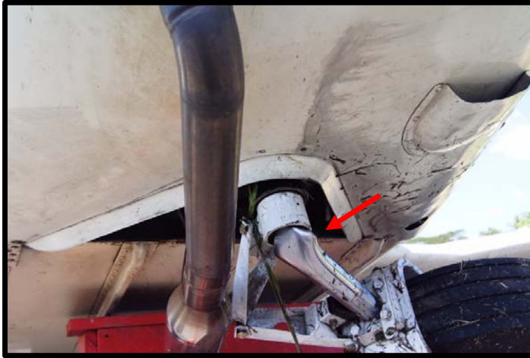
Fotografía No. 3 Amortiguador de Tren de Nariz quebrado.
