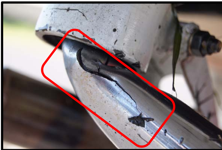
Fotografía No. 8 Amortiguador dañado.
