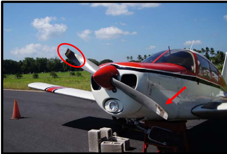
Fotografía No. 4 Daños en ambas aspas de la hélice.
