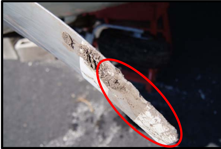
Fotografía No. 5 Nótese el daño en el aspa de la hélice.
